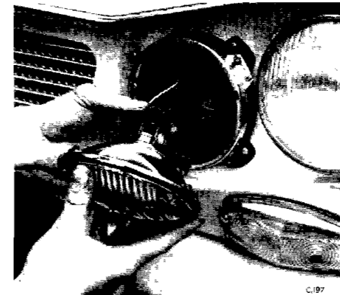
Fig. 48. Renewing light unit. Vitesse
